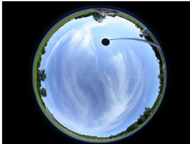
Joonis 2. Statiivil oleva looditud ja poolsfääriobjektiiviga kaameraga tehtud ülesvõte. Pildi servades on näha ka maapinda, kuna objektiivi vaatenurk on üle 180 kraadi. Päike on varjutatud eraldi ekraaniga, et vältida otsese kiirguse sattumist optikasüsteemi ja sellest tekkivaid sisepeegeldusi.
